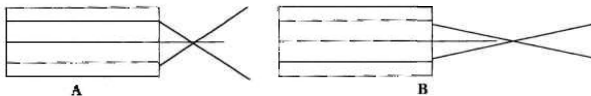
Figura 15 - Injeção na fibra com abertura numérica do feixe maior (A) e menor (B) que a abertura numérica da fibra
