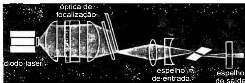
Figura 13. Esquema de uma cavidade para bombeamento longitudinal
