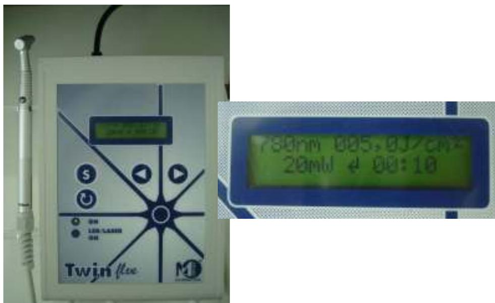
**Figura 4.** Laser de baixa potência diodo semiconductor e display com os parâmetros utilizados na pesquisa
