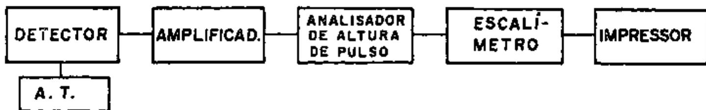
3-Diagrama em blocos do sistema de detecção e registro.
