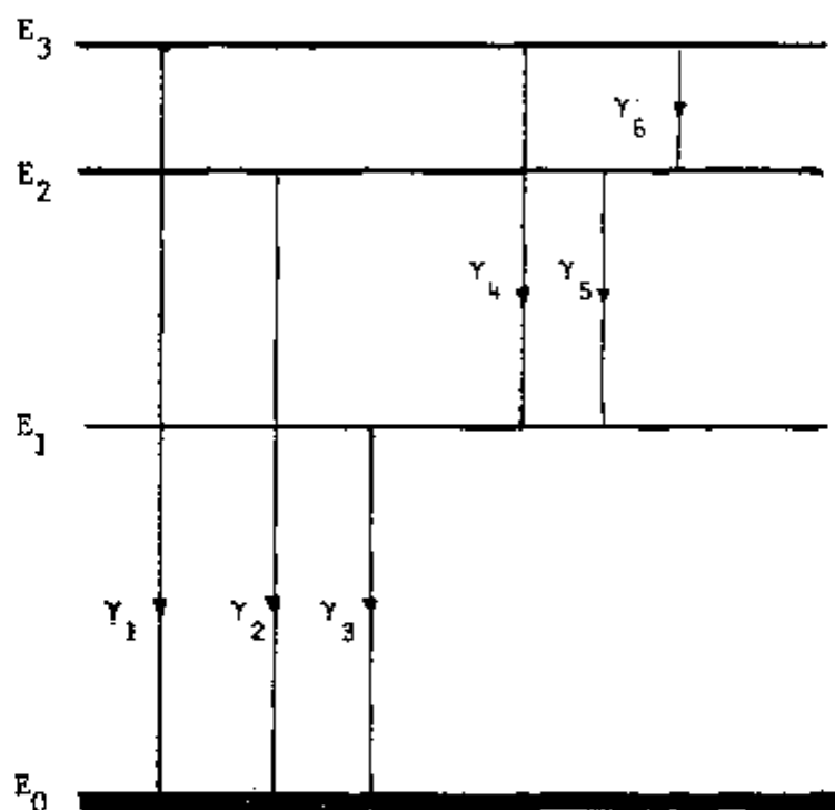
FIG. 1 - Representação esquemática de alguns níveis de energia de um núcleo no estado excitado e seu decaimento para o estado fundamental E_0 , liberando energia pela emissão de raios gama. A energia do raio gama é igual à diferença, em energia, entre os níveis: E_\gamma = E_i - E_f
