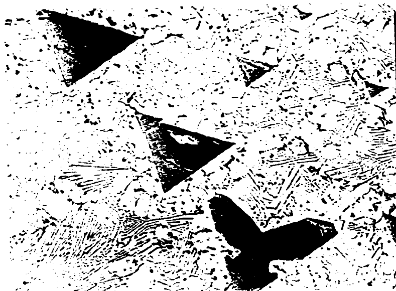
Foto 23- Detalhe da foto 22, mostrando os cristais de UAl_3 para os quais se acompanhou a cinética de crescimento da fase UAl_4 a 600^\circ C . (580x)
