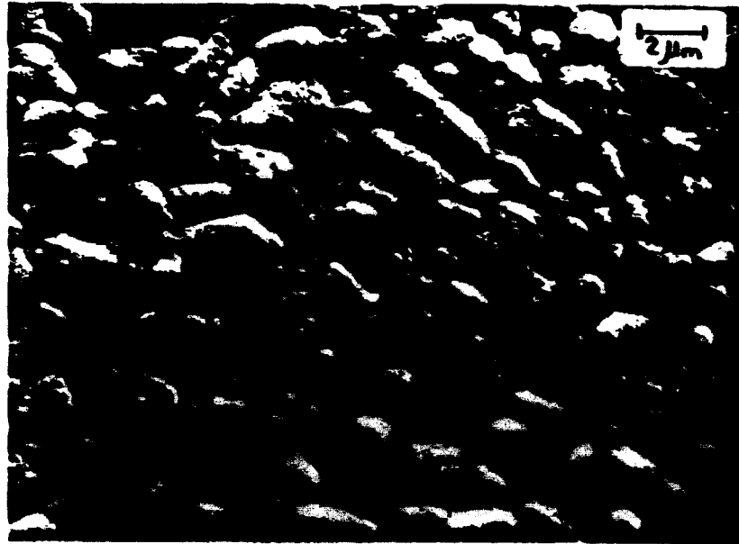
FIGURA III.21 - Micrografia eletrônica de uma microesfera sinterizada a 1100^{\circ}\text{C} ( t=5 horas).
