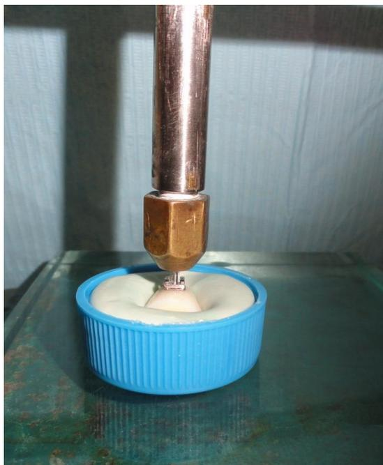
**Figura 11** - Colagem do braquete na superfície vestibular do dente bovino empregando-se a Agulha Maior de Gilmore para padronização da posição e carga.
