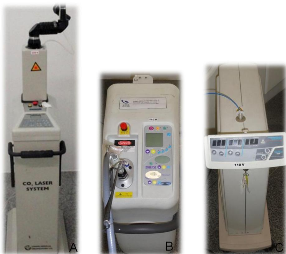
**Figura 8** - Equipamentos *laser* empregados neste estudo. Em (a), *laser* de CO<sub>2</sub>, em (b), *laser* de Er,Cr:YSGG e, em (c), *laser* de Nd:YAG.
