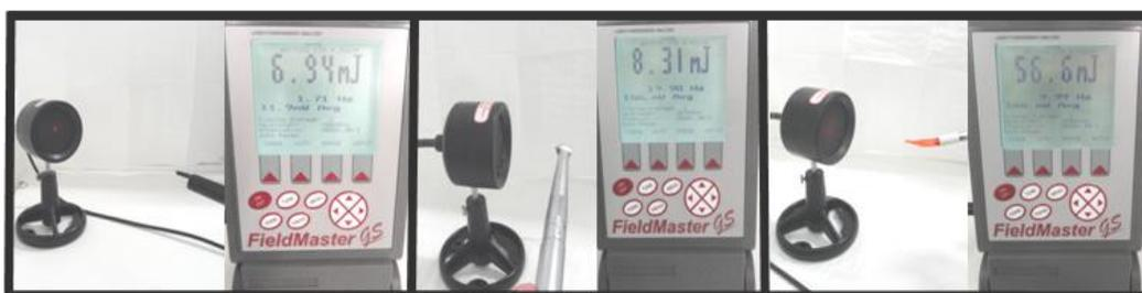
**Figura 7** - Aferições das energias por pulso (mJ/pulso), por medidor de energia, realizadas antes de cada irradiação *laser*. Em (a), para *laser* de CO<sub>2</sub>; em (b) para *laser* de Er,Cr:YSGG e, em (c), para *laser* de Nd:YAG.
