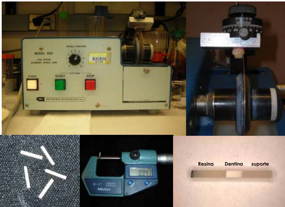
Figura 12. Amostra sendo seccionada em paralelepípedos de aproximadamente 1\text{mm}^2 .
